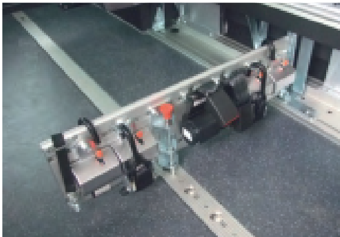
🇩🇪 Diverse Einrastpositionen und verschiebbare Tragarme ermöglichen die sichere Befestigung kurzer oder langer Rollstühle 🇬🇧 Wide range of positions and slidable support arms for safe fixture of both short and long wheelchairs 🇫🇷 Diverses positions de verrouillage possibles, selon la taille des fauteuils roulants
